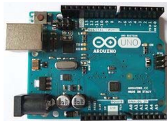
Arduino UNO R3: hier: ATmega328 Microcontroller in SMD-Bauweise
